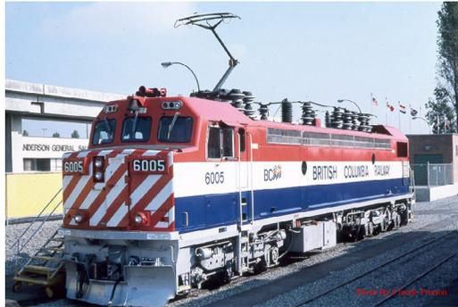
Die Auslieferung der neuen Loks erfolgte von Dezember 1983 bis August 1984. Die GF6C basierte auf dem Fahrwerk der SD40-2. Da die schwedische Elektrik weniger Platz benötigte als Dieselmotoren, wurden die Zwischenräume mit Betongewichten aufgefüllt, um ein Gewicht von 199 t zu erreichen.
