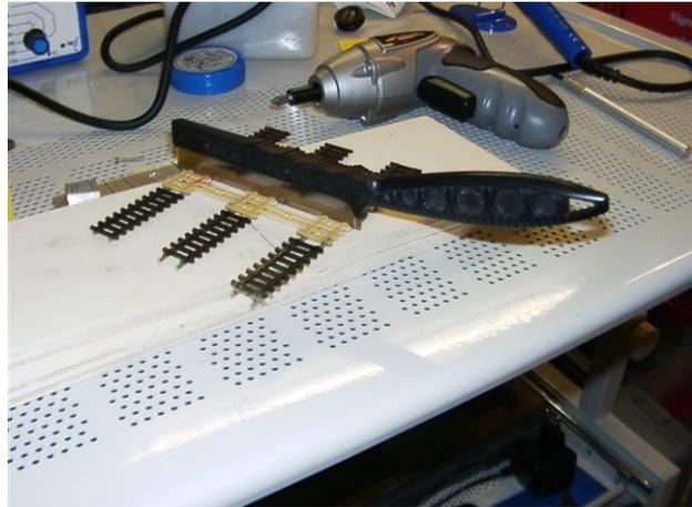
Durch die vorgebohrten Löcher in der Lötlehre ergibt sich bei Umdrehen des ganzen Stückes ein kleiner Spalt zwischen den fertig verlöteten Schwellenbändern. In der Bildmitte links ist das gut zu sehen. In den Spalt passt genau die Roco-Bastelsäge auf dem Bild rechts. Diese Säge ist seit 3 Jahren im Einsatz, mit ihr wurde - außer gehärtetem Stahl - schon jedes Material gesägt und sie ist immer noch scharf!
