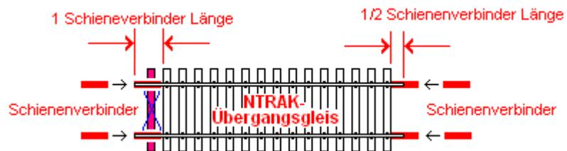
Die nächste Abbildung zeigt die Situation eines Gleises (z.B. RED-Line) bei zwei zusammengestellten Modulen inklusive bereits eingelegtem NTRAK-Übergangsgleis. Auf der rechten Seite wurde es mit den 1/2 Schienenverbindern auf das Modulgleis eingefädelt. Auf der linken Seite müssen nun noch die Schienenverbinder zur Hälfte auf das Modulgleis geschoben werden.
